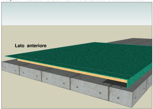
5) Fissare il telo lungo il lato anteriore utilizzando un tassello ogni 25 cm. Mantenete il telo sempre ben teso aiutandovi con una pinza: durerà più a lungo e permetterà un miglior scorrimento dei liquidi. All'occorrenza sul lato anteriore si può prevedere anche l'utilizzo di una piattina di acciaio per un migliore fissaggio del telo. Chiudere anche la parte laterale di inizio della fila di cuccette fissando un tassello ogni 50 cm. circa
